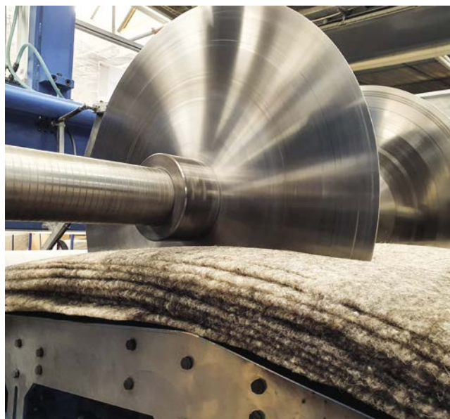
Schneiden des Dämmstoffs.
